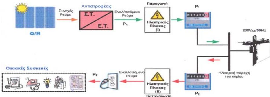
Με αυτό τον τρόπο η μέτρηση της παραγόμενης από το ΦΒ σύστημα ενέργειας και η μέτρηση της ενέργειας που καταναλίσκεται από την εγκατάσταση συσχετίζονται και κατ' ουσία συνιστούν ενιαίο σύνολο και για το λόγο αυτό η σύνδεση αντιστοιχεί σε υφιστάμενο αριθμό παροχής της ιδιοκτησίας του κυρίου του ΦΒ συστήματος.
